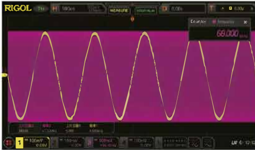
Измерение частоты встроенным частотомером
