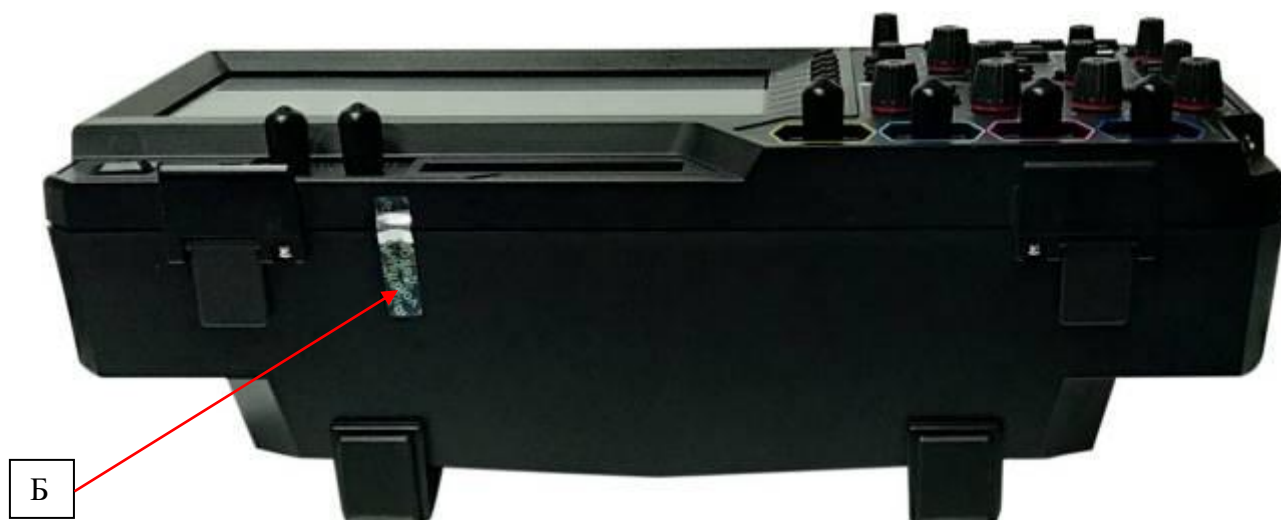
Рисунок 6 – Схема пломбировки от несанкционированного доступа (Б)
