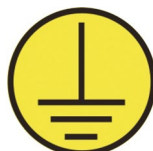
Клемма защитного заземления
