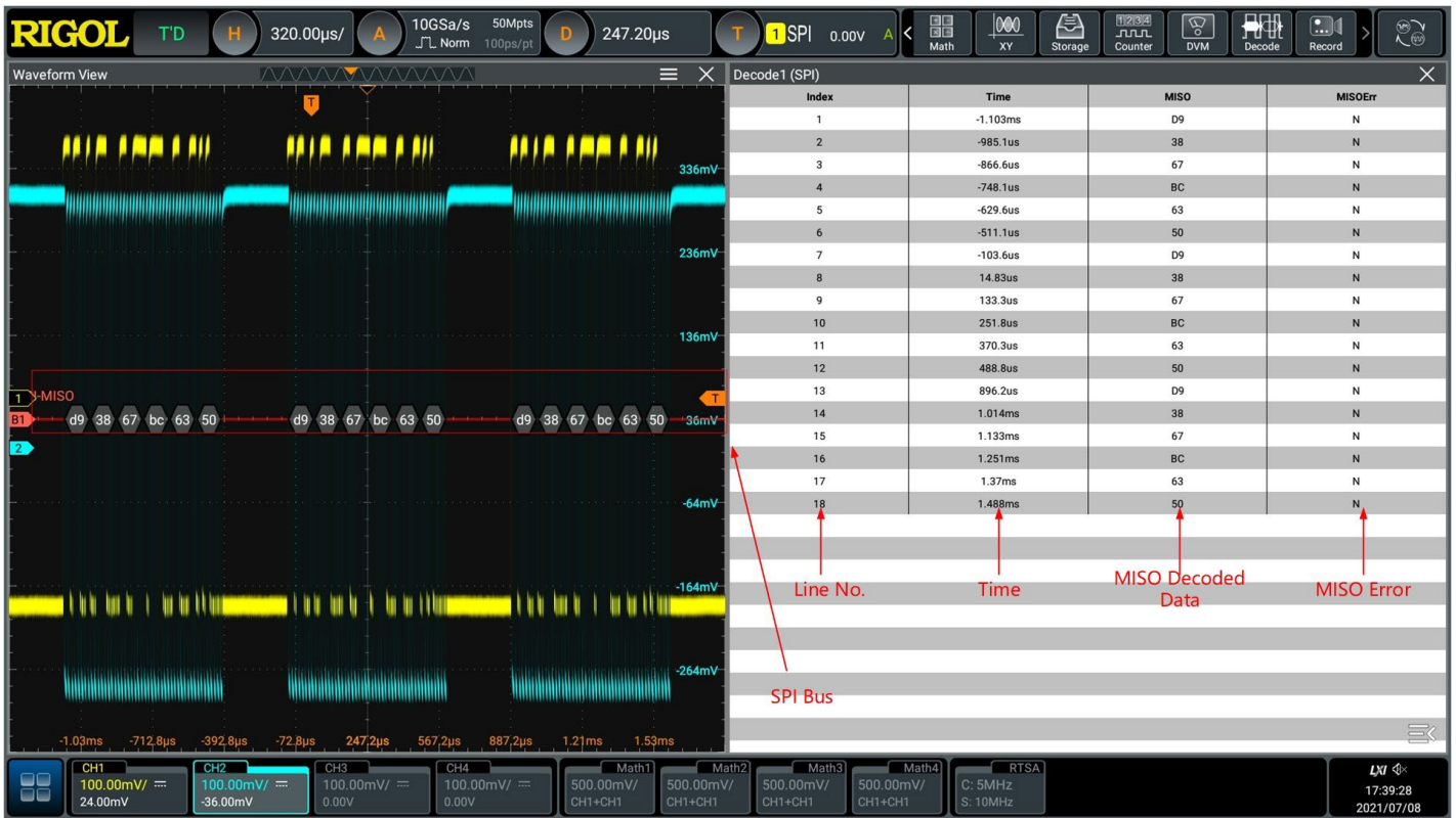
Рисунок 17.13 Таблица событий декодирования SPI
