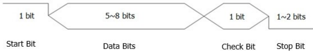
Рисунок 8.24 Схема протокола RS232
