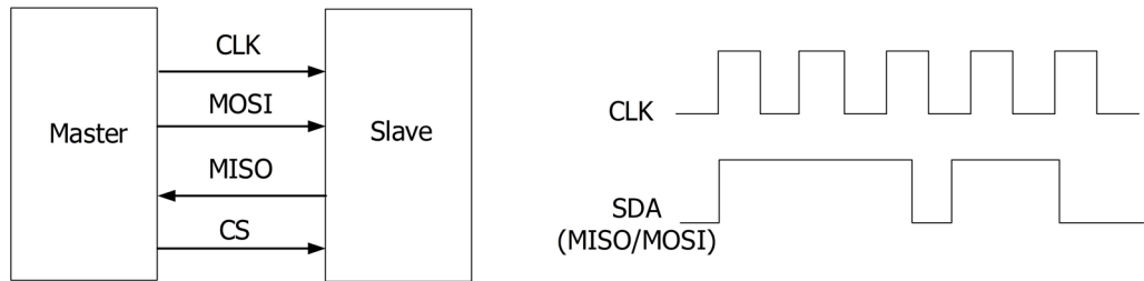
Рисунок 17.11 Последовательная шина SPI
